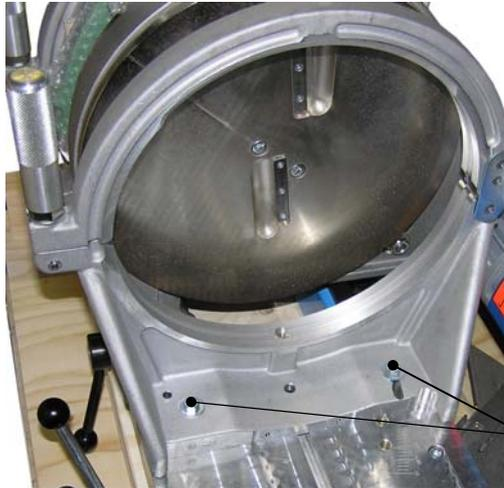
Zum Wechseln der Spannwerkzeuge werden die Befestigungsschrauben demontiert und die Rohrspannwerkzeuge entnommen.
